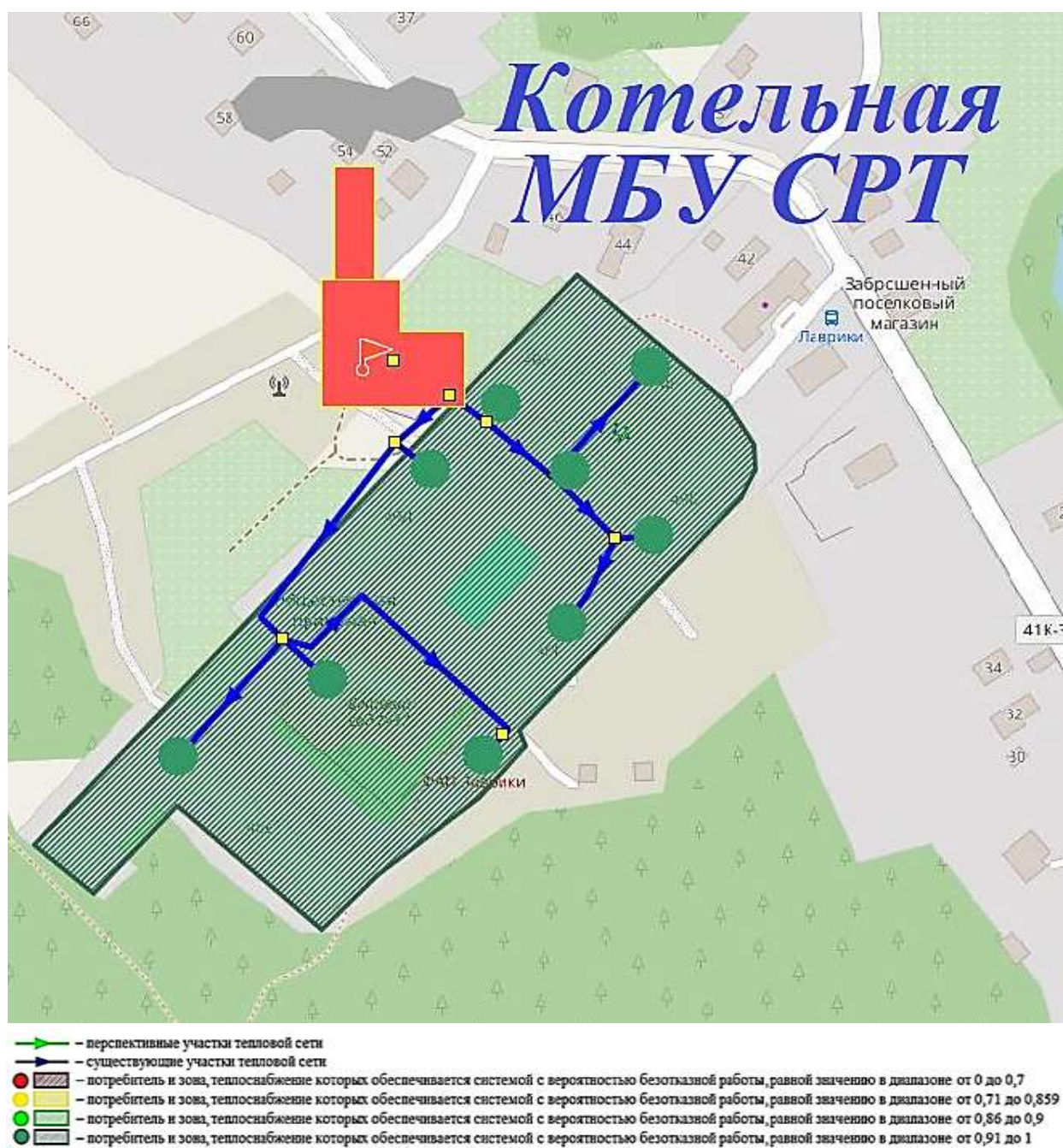
Рисунок 16. Зоны, характеризующие надежность теплоснабжения потребителей котельной МБУ «СРТ» на период до 2030 года
